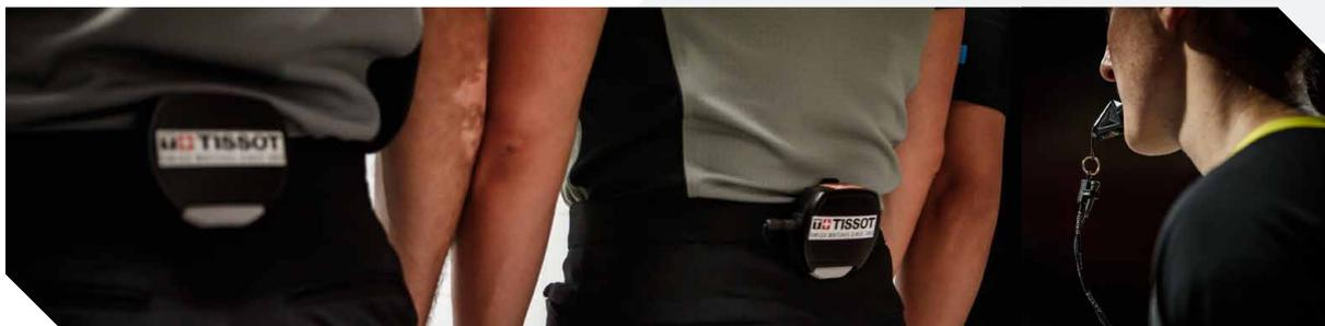
Le système de chronométrage commandé par le sifflet fonctionne par l'intermédiaire d'un émetteur radio attaché à la ceinture portée par les arbitres. Un micro omnidirectionnel, relié au pack-ceinture, est placé dans l'adaptateur-micro situé sur le cordon en dessous du sifflet.
